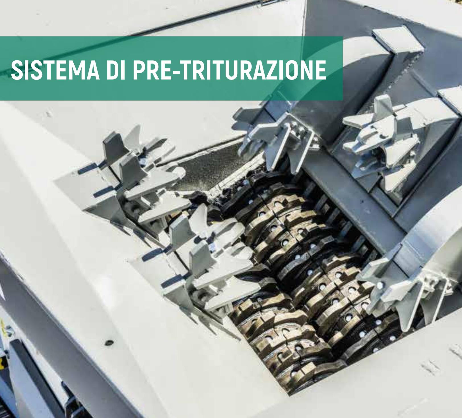
Il sistema brevettato degli spintori idraulici CAMS™, permette di caricare anche i blocchi più grandi direttamente nell'unità di triturazione.
