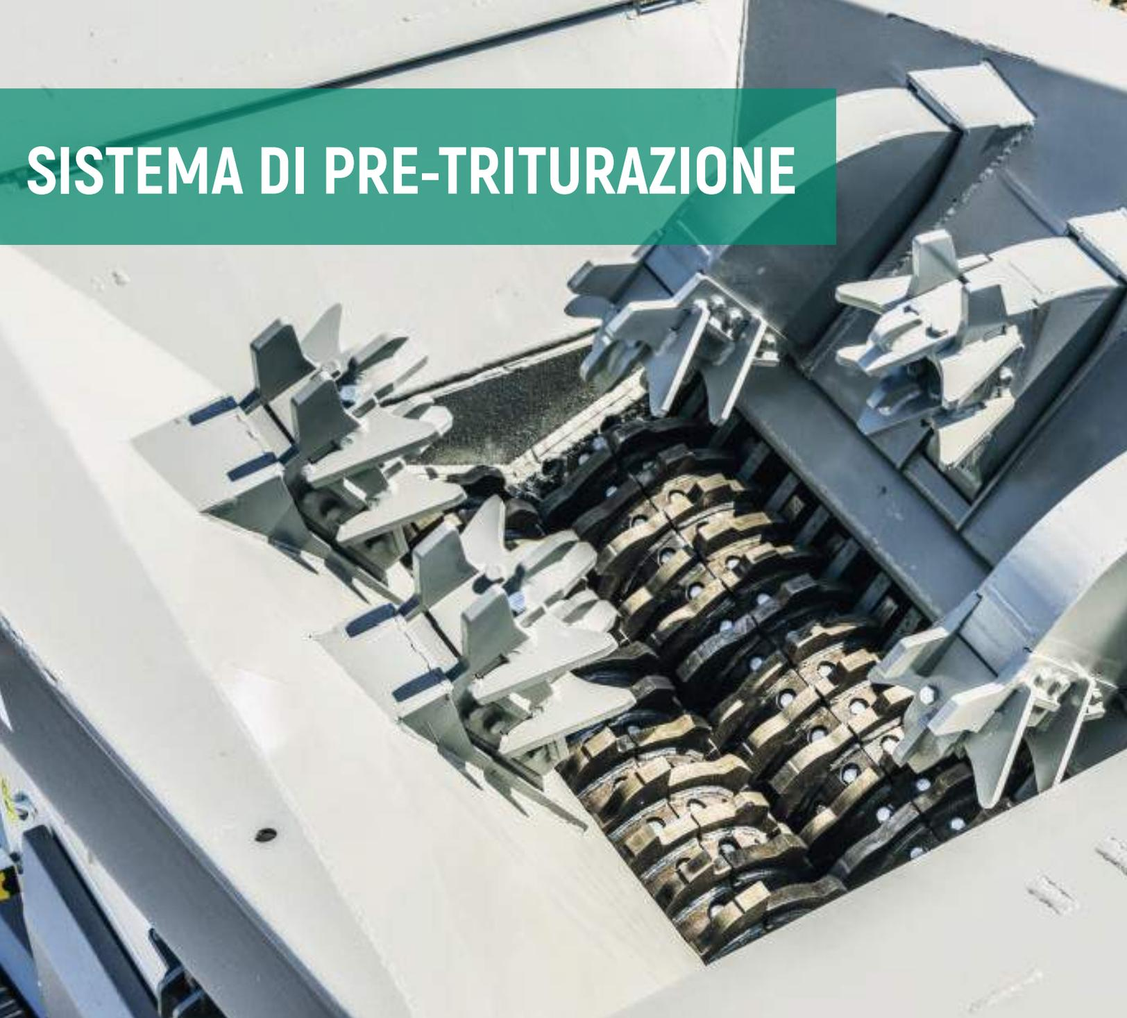
Il sistema brevettato degli spintori idraulici CAMSTM, permette di caricare anche i blocchi più grandi direttamente nell'unità di triturazione.
