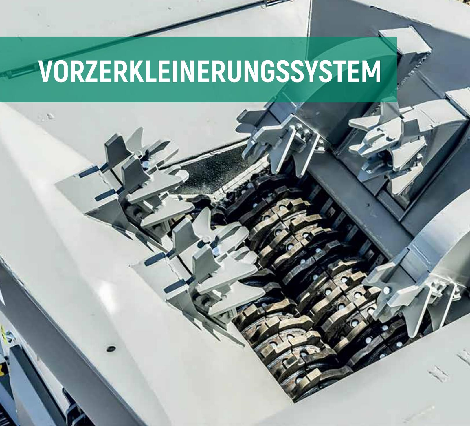
Das patentierte System der hydraulischen Schubvorrichtung CAMS ermöglicht es, auch größere Blöcke direkt in den Häcksler einzuführen.
