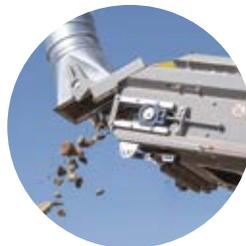
Un flux d'aspiration transporte les déchets légers dans un caisson fermé
