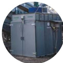
Box dotato di carrello interno per svuotamento rapido
